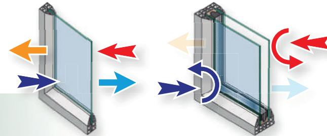
ción. Esto se debe a que el perfil interior de la ventana está por debajo del punto de rocío y hace que aparezcan esas gotas que "sudan" de la ventana. La Rotura del Puente Térmico eleva la temperatura superficial de la parte interna y de esta manera se reducen las posibilidades de condensaciones o lo que comúnmente llamamos "sudar".
